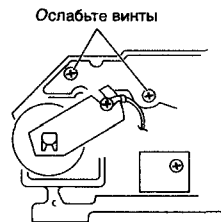
Рис. 9. Ослабьте крепежные винты скребка с передней стороны узла проявителя
